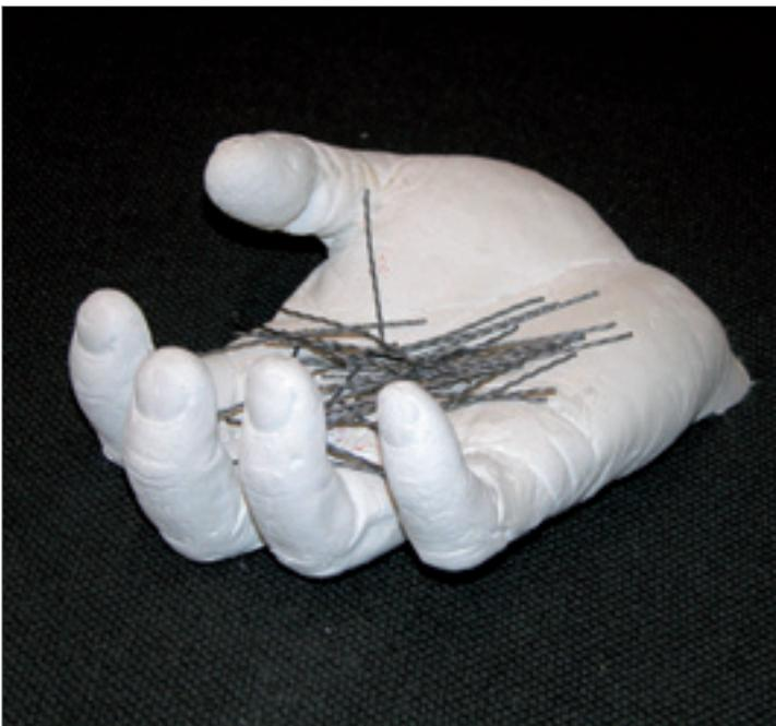
Metalldrähte zur Armierung des flüssigen Betons
