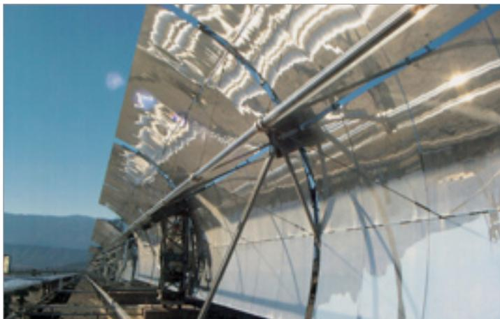
Neue Technologie: Parabolrinnen und Parabolspiegel bündeln Sonnenwärme, um Wasser zu erhitzen.
